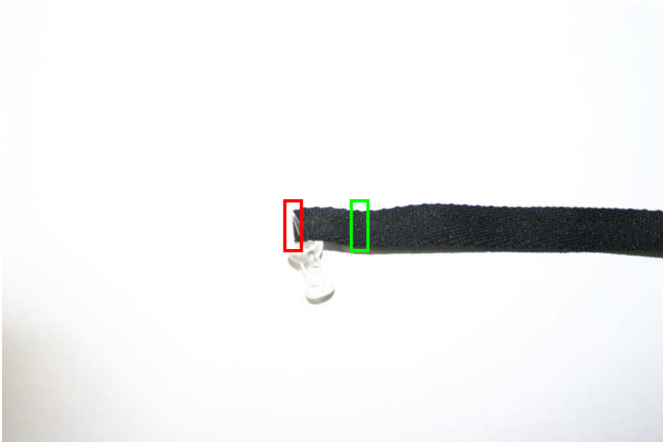
Abbildung 3: Grünes Rechteck: reguläre Position der drei Nahtreihen, mit welcher die Schlaufenenden am Griff befestigt sind. Rotes Rechteck: Position der drei Nahtreihen im vorliegenden Fall, wobei nur die innerste Naht am Schlaufenende „greift“.
